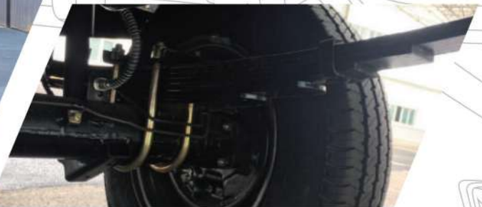
Enam bar Upper Leaf dengan ground clearance yang lebih tinggi agar dapat akses dengan baik di berbagai kondisi jalan
