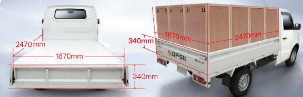
4–strip Cubical Support Rack dengan 16 buah Cargo Bed Reinforcement Bars agar lebih tahan lama
