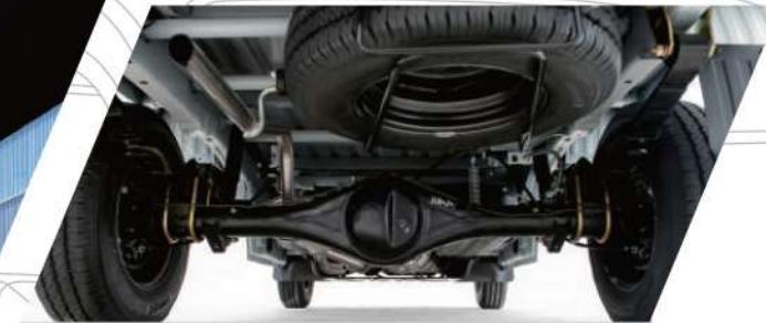
Beam di desain Nine–horizontal Two–longitudinal dengan kapasitas yang besar
